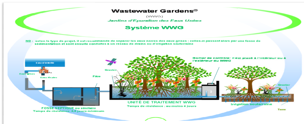
Figure2 : schéma présentant le principe de fonctionnement du système « jardin d'épuration »
