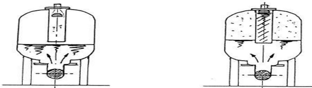
**Figure 36 :** Principe de fonctionnement de l'ARAA [Charlatte]
