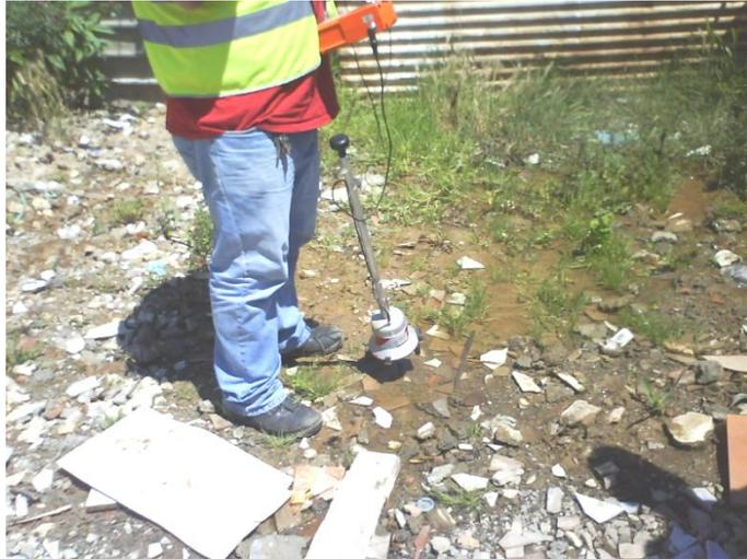
**Figure IX.18:** Recherche des fuites avec un amplificateur électronique.
