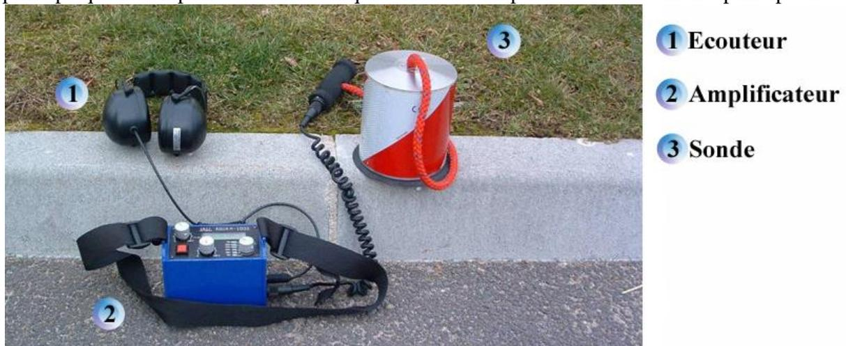
**Figure II.6 :** Amplificateur électronique
