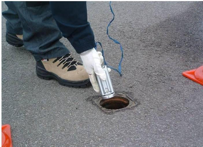
**Figure II.13 :** *Positionnement des sondes*
