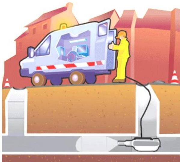
**Figure VIII. 1 :** *L'inspection visuelle des réseaux d'assainissement.*
