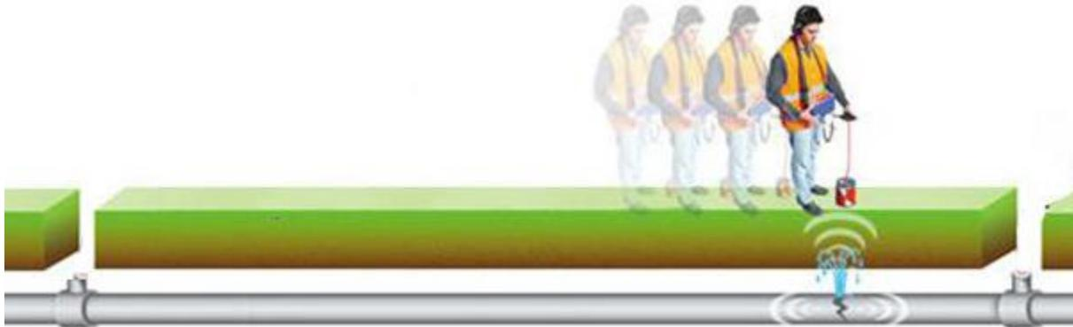
**Figure II.7 :** Recherche des fuites avec un amplificateur électronique
