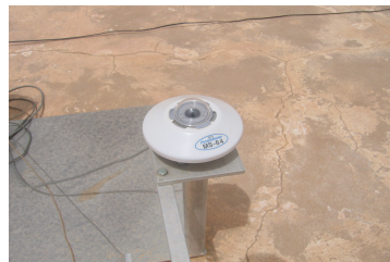
Figure 4.12 : Un pyranomètre de type Kipp et Zennen
