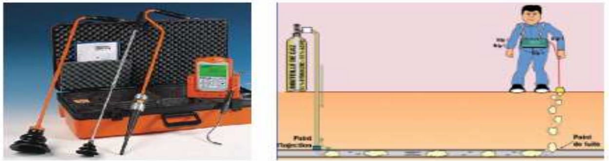
Figure V-7 : Principe de fonctionnement d'un Gaz traceur
