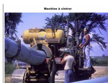
figure I.2 : machine de cintrage
