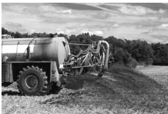
Figure 9 : L'épandage de boues liquides réalisé par le biais de la tonne à lisier
