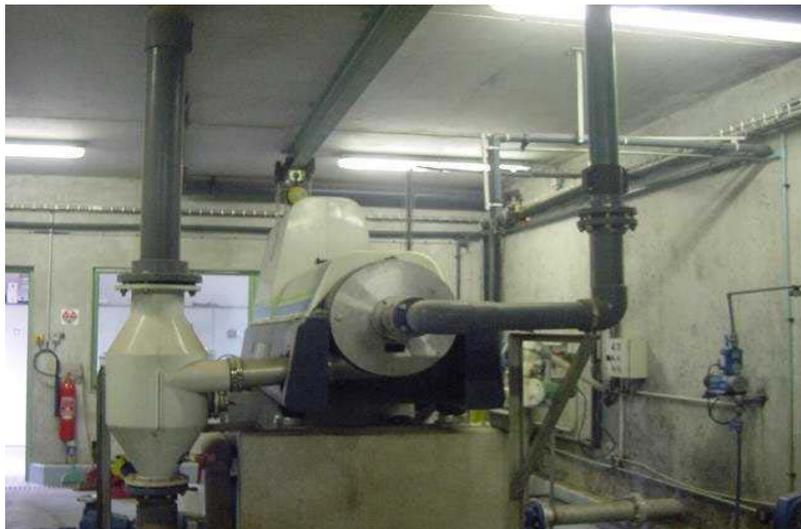
**La figure II.16 : Centrifugeuse.**
