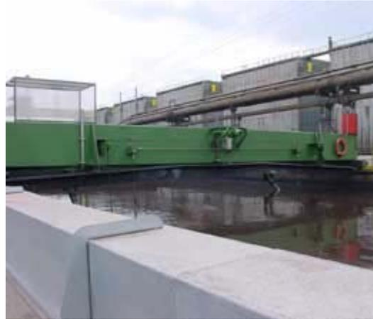
**Figure II.6 : Décanteur rectangulaire**
