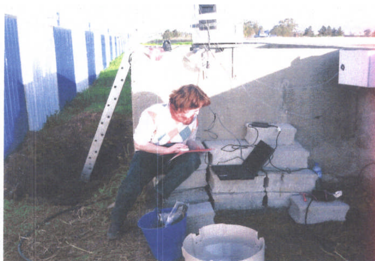
Photo 8 : Vérification de l'état de fonctionnement du préleveur N°1 au niveau d'ouvrage de sortie de décanteur secondaire par le personnel VATECH/WABAG (25février 2006)
