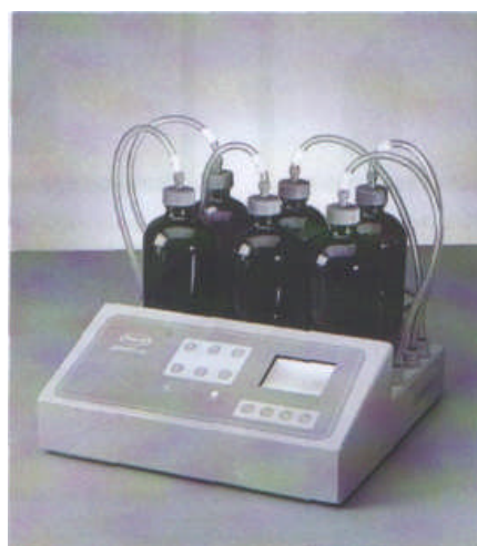
Photo 9 : BODTrak pour la mesure de la DBO
