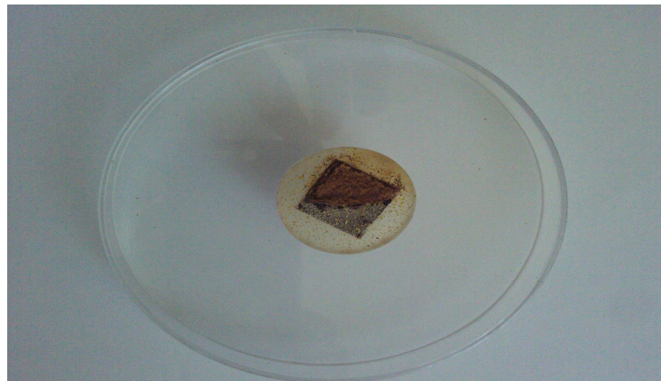
Figure II.9 : présente un échantillon d'acier au carbone X70 après dix jours d'immersion.
