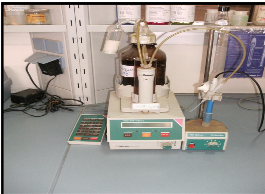
Burette automatique pour mesurer l'alcalinité
