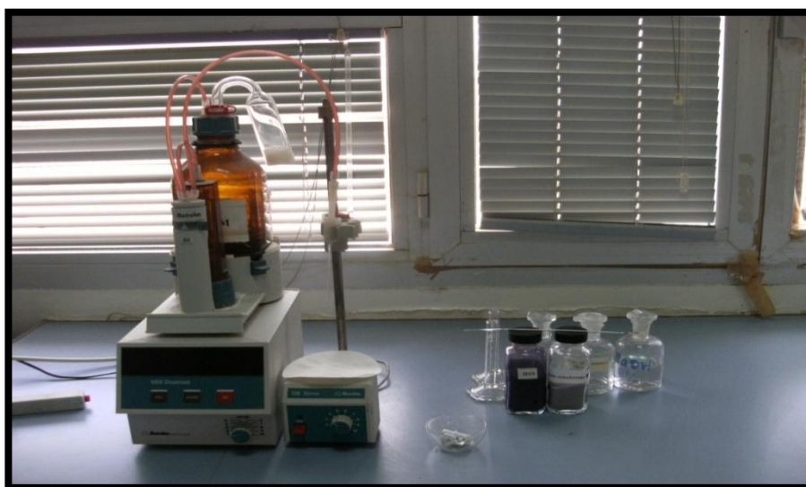
Burette automatique pour mesurer la dureté
