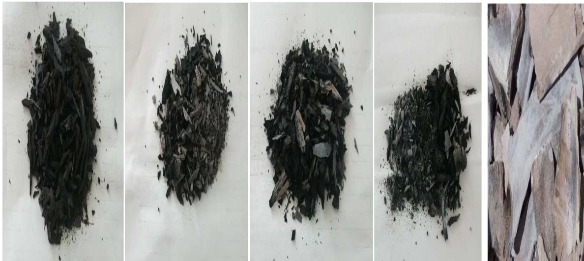
**Figure V.17:** L'os calcinés à des températures (400°C; 600°C; 700°C; 800°C et 900°C) avant le broyage
