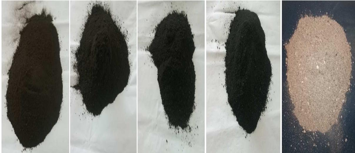
**Figure V.15:** L'os broyés à des températures (400°C; 600°C; 700°C; 800°C et 900°C) après le broyage.
