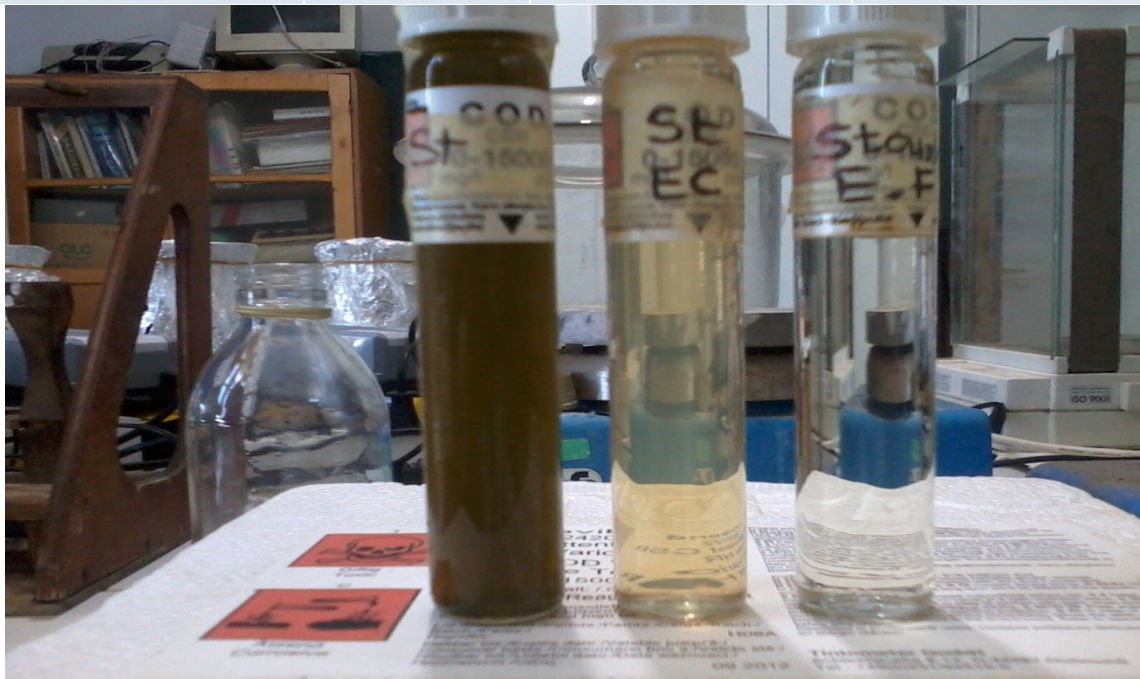
Figure IV.22 : dégradation de la couleur après traitement
