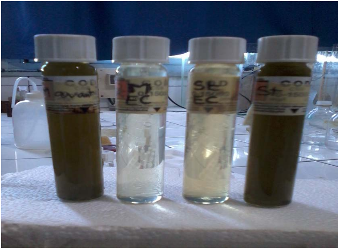
Figure IV.12 : dégradation de la couleur après traitement
