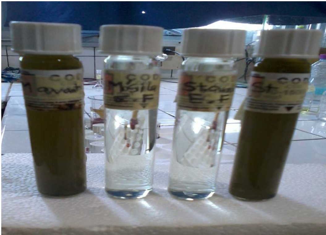
Figure IV.19 : dégradation de la couleur après traitement
