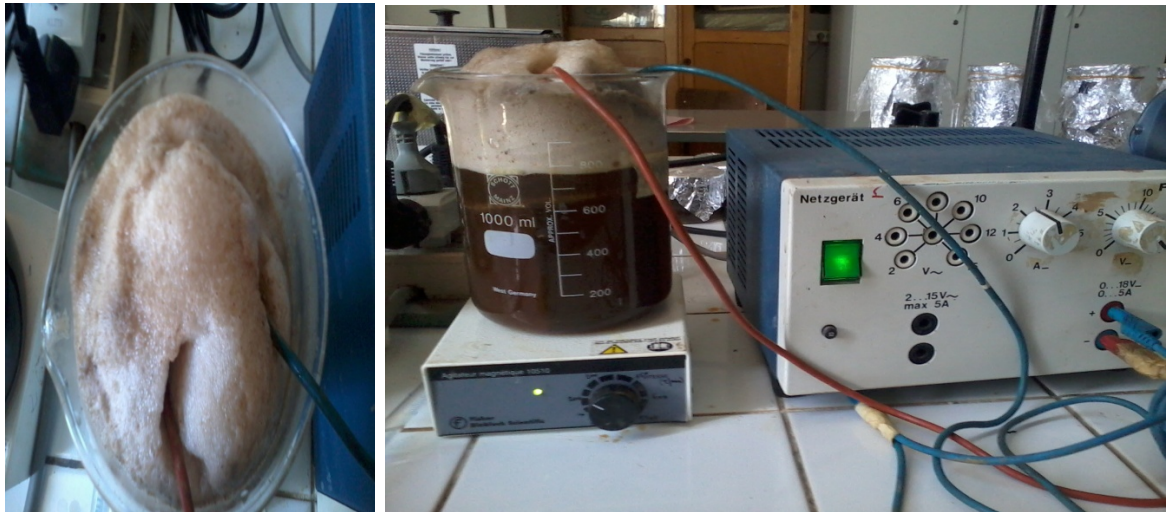
Figure IV.18 : changement de la couleur et formation des boues au cours de traitement par l'électro-fenton
