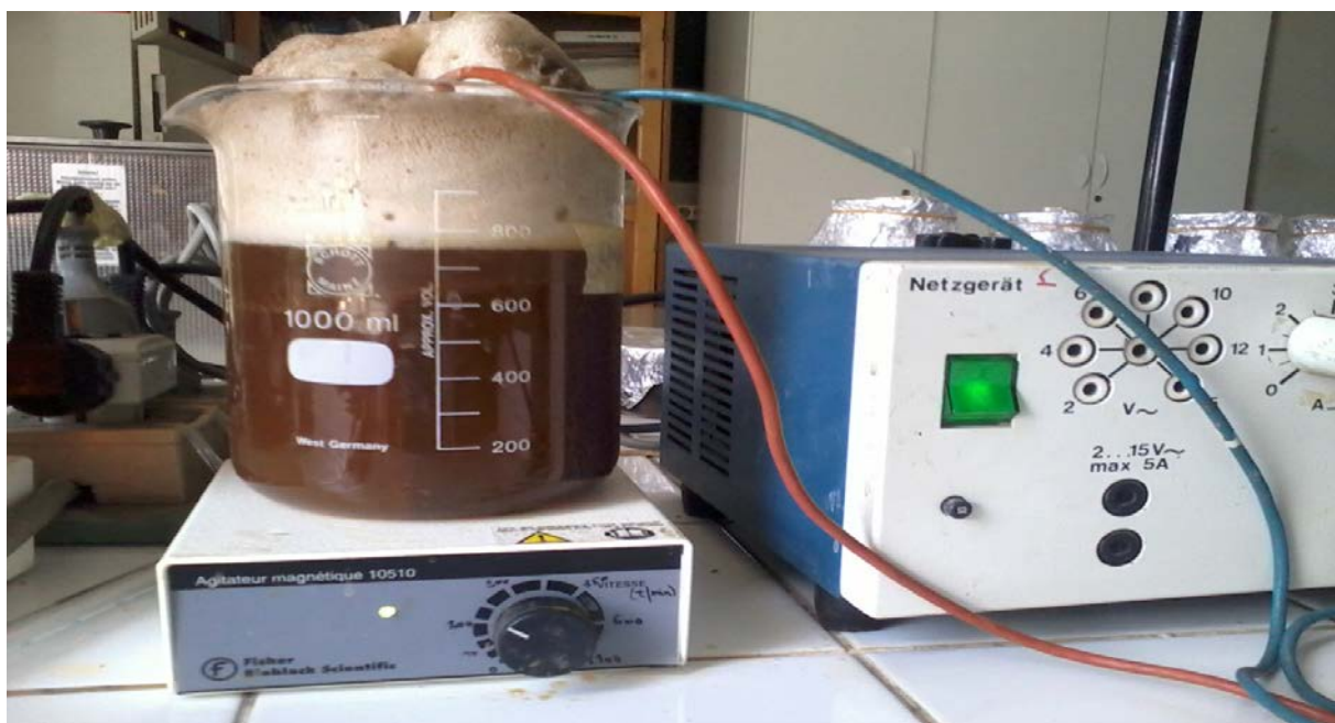
Figure IV.13 : montage du réacteur d'électro-fenton au cours du traitement
