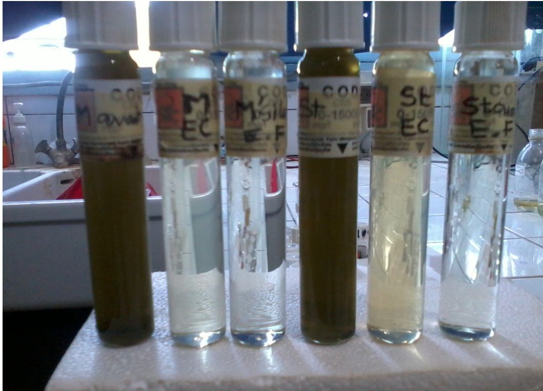
Figure IV.23 : dégradation de la couleur après traitement
