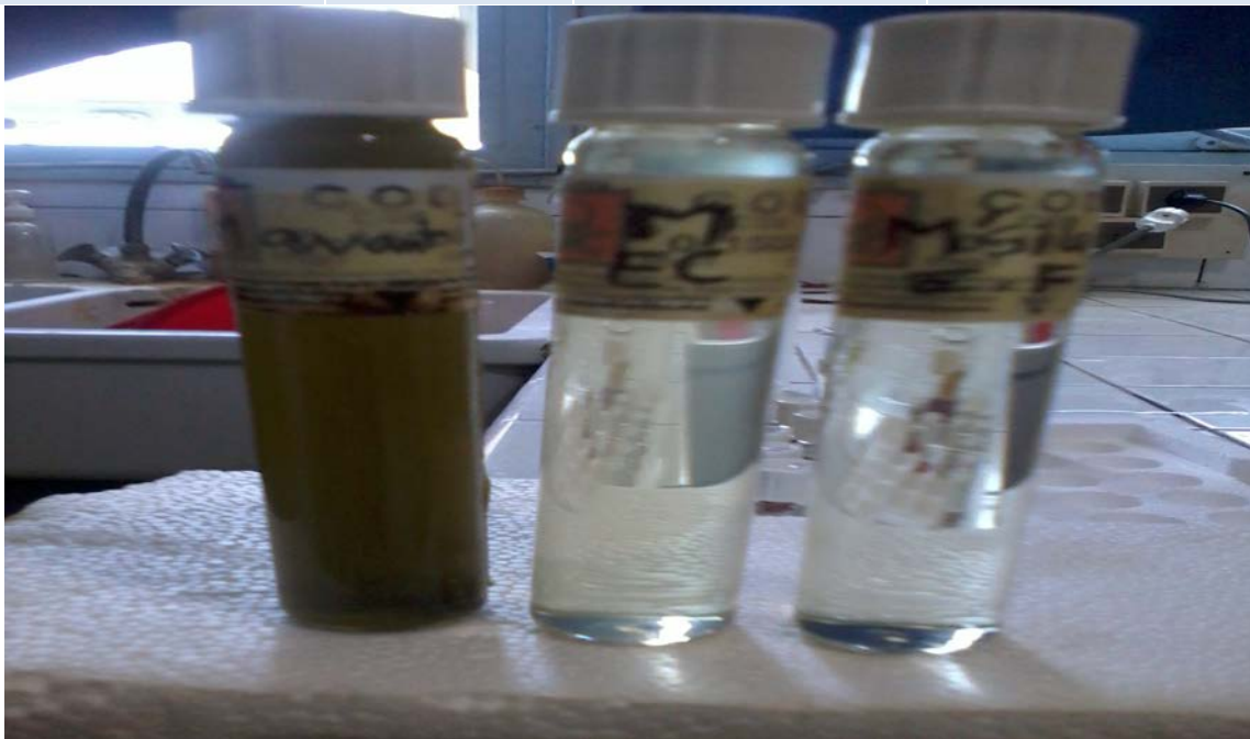
Figure IV.21 : dégradation de la couleur après traitement
