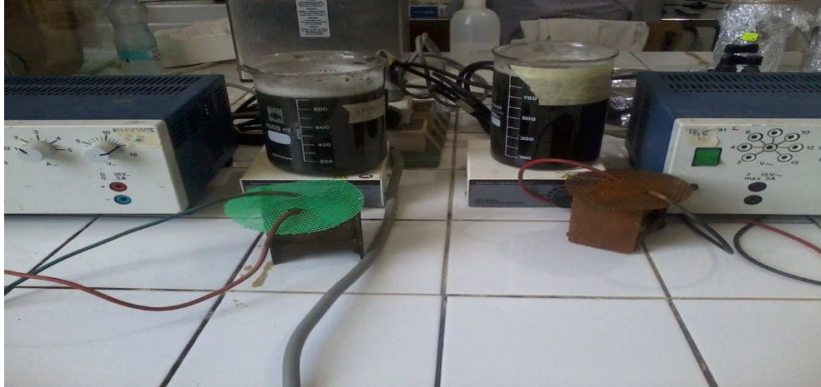
Figure V.4 : montage du réacteur d'électrocoagulation avant commencer le traitement
