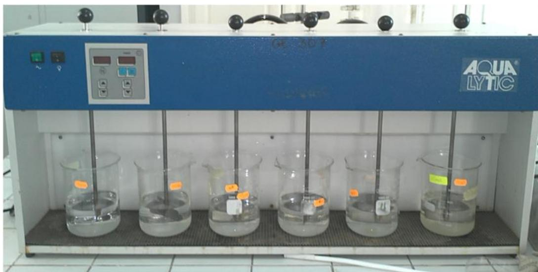
**Figure 10** : L'essai du jar test
