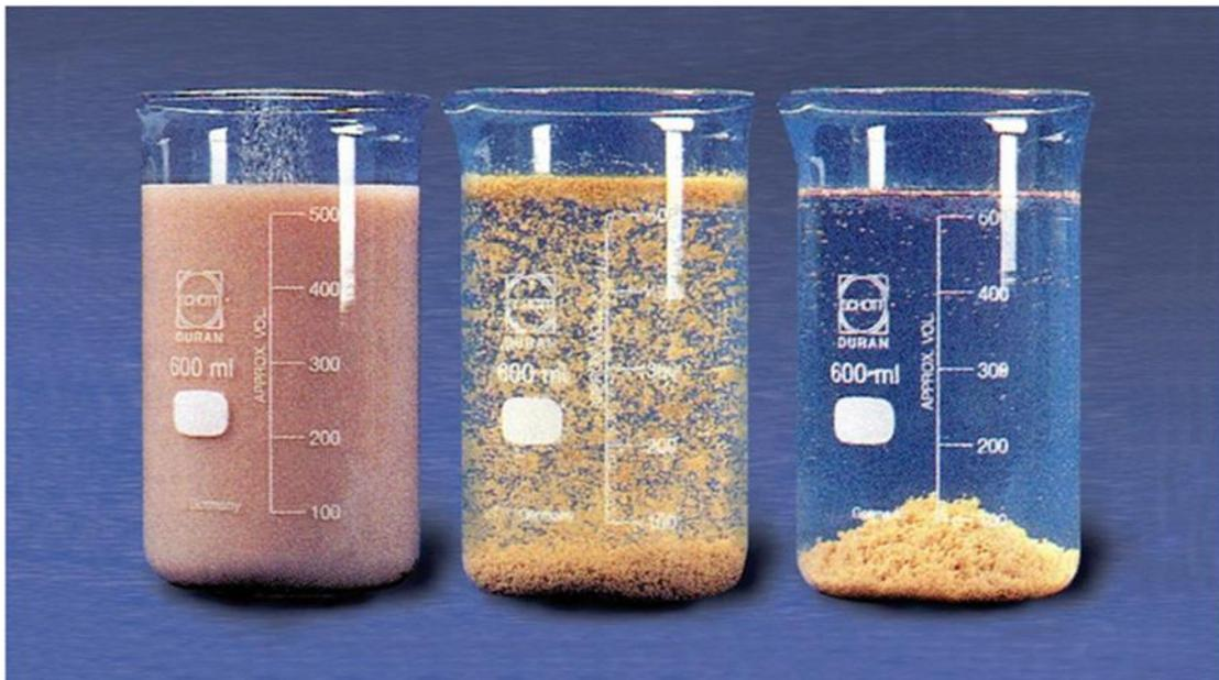
Figure4: procédé coagulation floculation.[44]
