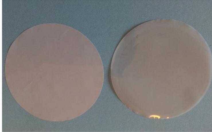
**Figure N°12** : Photo du filtre de porosité 0,4  $\mu\text{m}$  avant et après dépôts.
