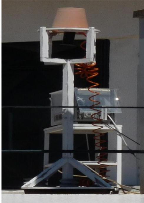
Figure N°10 : Photo de l'appareil d'échantillonnage (LVS).
