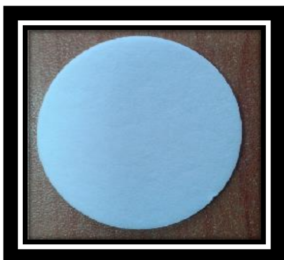
Figure VI.6 Filtre avant prélèvement
