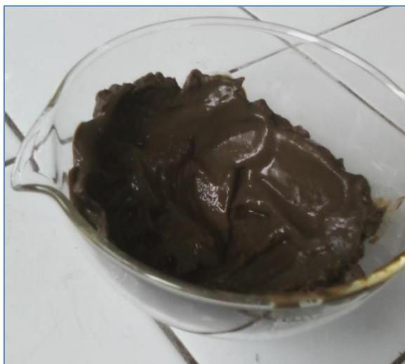
**Figure 4.05** : La soda-lignine avant séchage
