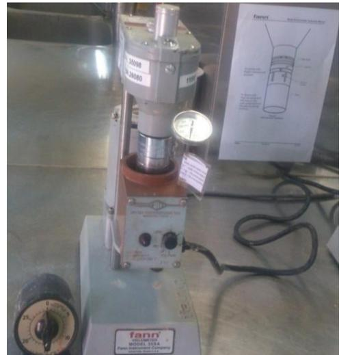
Figure A.6 : Rhéomètre de FANN
