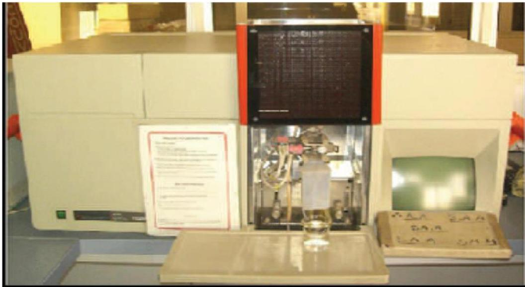
Figure A.11 : Spectrophotomètre d'adsorption atomique.
