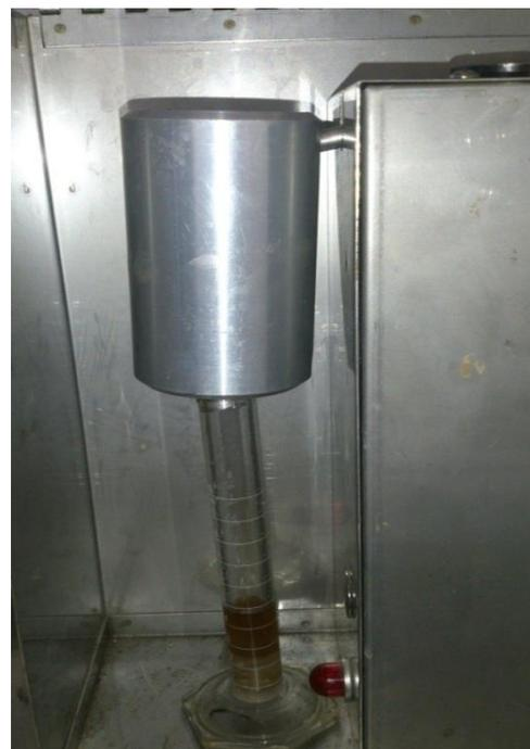
Figure A.13 : Distillateur à boue
