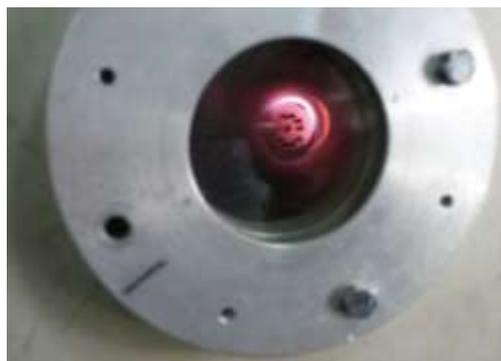
**Figure 13: photo représentant les échantillons de PVC face au plasma d'Argon**
