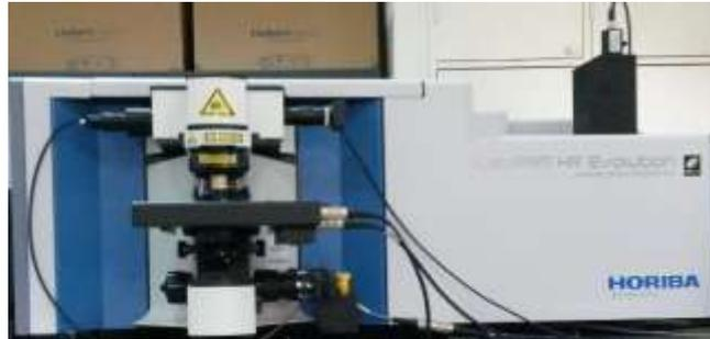
**Figure 17: Spectroscopie HORIBA-LabRAM HR (CDTA)**
