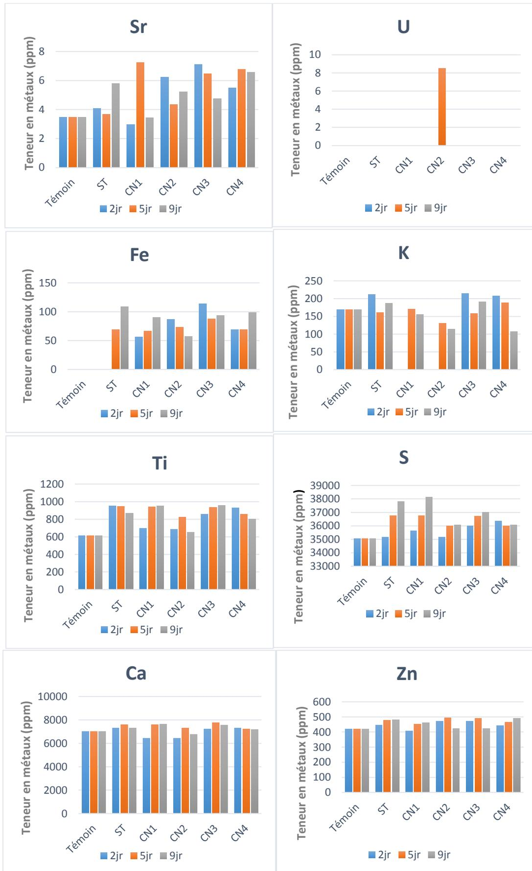
Figure 32: Histogrammes représentant les teneurs en métaux lourds et en soufre détectés dans le cas des échantillons de PVC non traitées et traitées.
