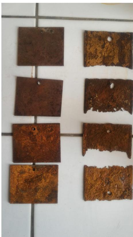
FIGURE III.2.8 – Dégradation des électrodes après traitement par l'électro-coagulation
