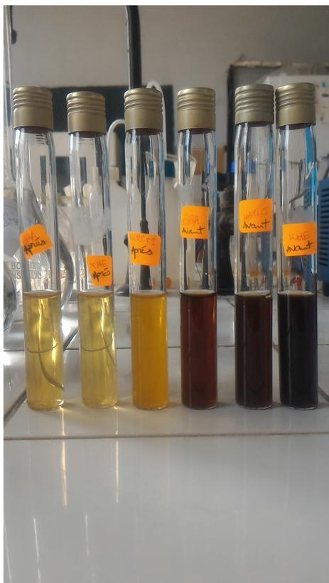
FIGURE III.2.7 – Dégradation de la couleur après traitement par l'électro-coagulation
