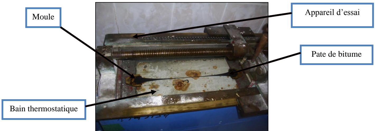
Figure IV.12. Essai de ductilité
