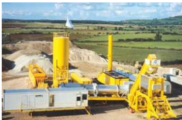
Figure II.3. Centrale d'enrobage continue de la marque ERMONT [14]
