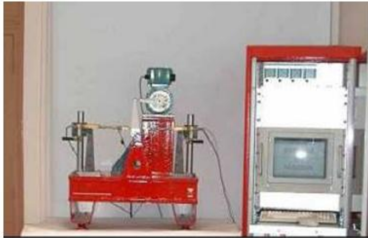
Figure II.26. Essai de fatigue en flexion 2 points sur éprouvettes trapézoïdales [21].
