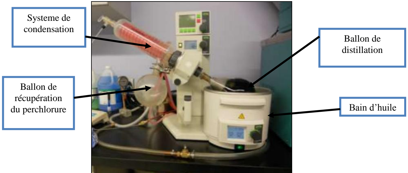
Figure IV.18. Appareil d'extraction du perchlorure de la solution contenant le bitume vieilli
