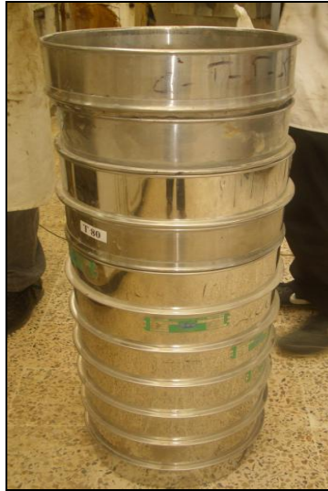
Figure IV.6. Série de tamis (0,08-20mm)
