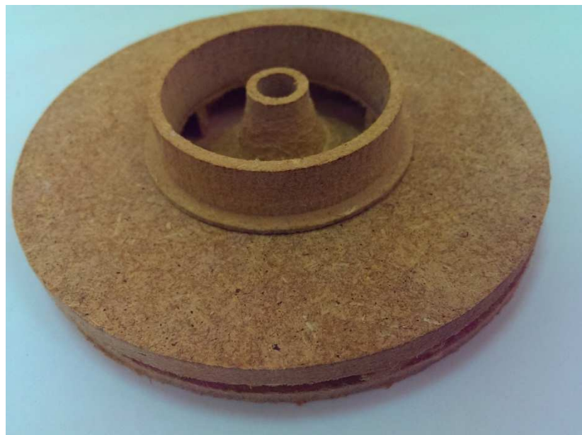
Figure 5- 34 : La roue usinée
