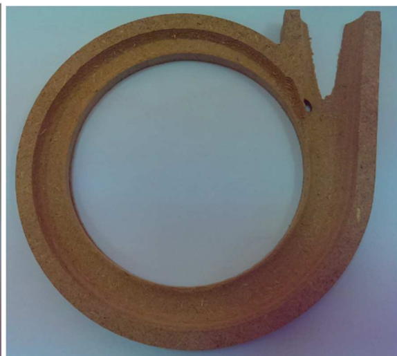
Figure 5- 23 : L'usinage de la deuxième tranche de la volute
