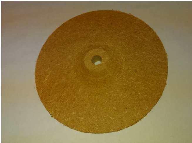
Figure 5- 28 : L'usinage de la première tranche de la roue
