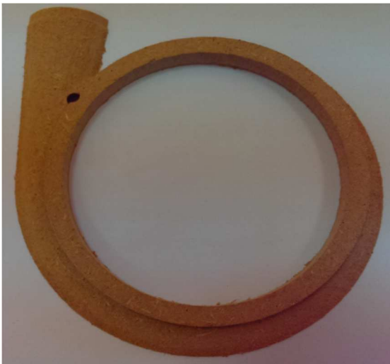
Figure 5- 22 : L'usinage de la première tranche de la volute
