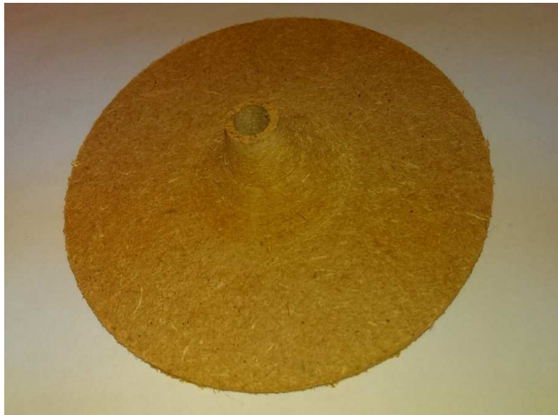
Figure 5- 30 : Le collage des deux tranches donne le flasque arrière
