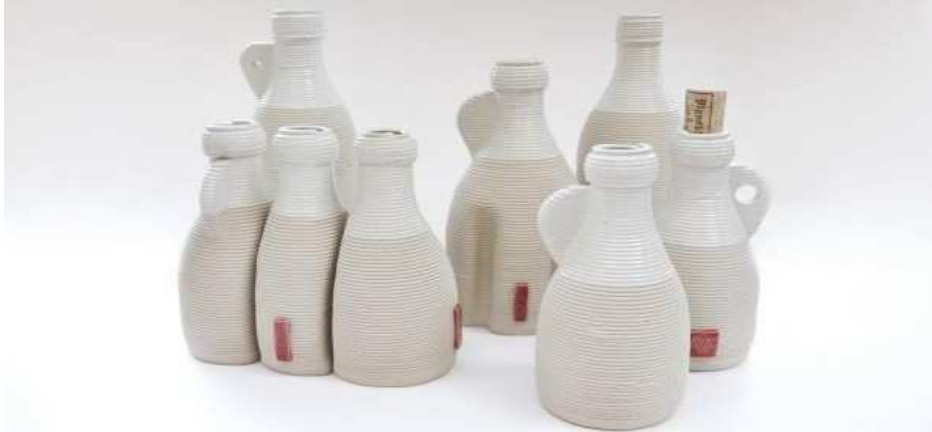
Figure 4- 9 : Objets imprimés en céramique
