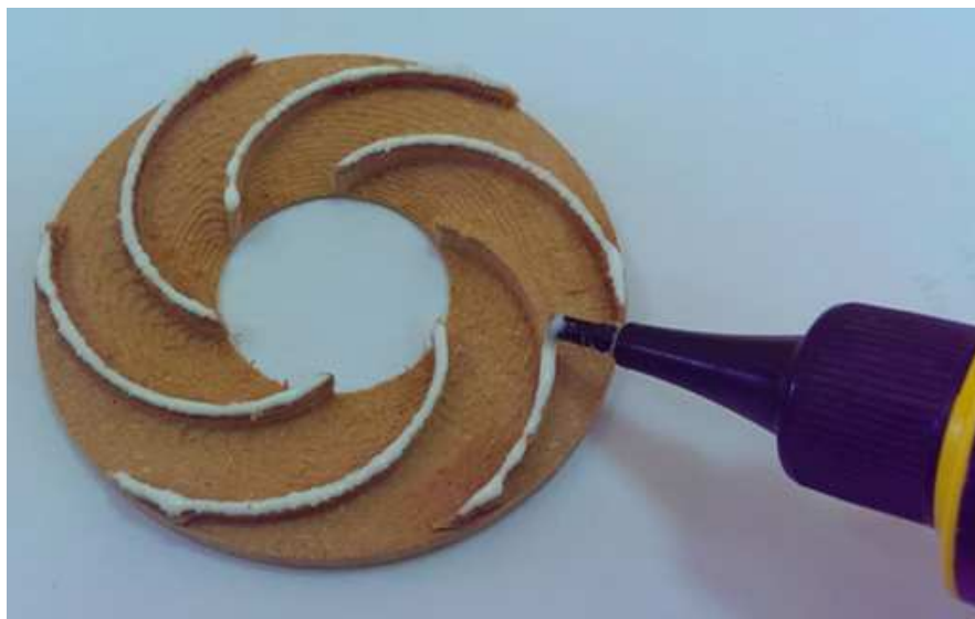
Figure 5- 33: Le collage de la roue
