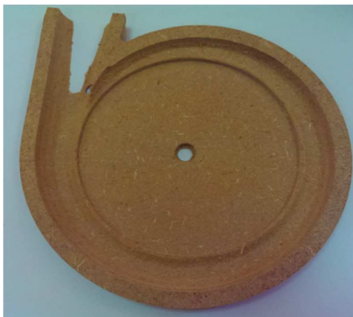
Figure 5- 24 : L'usinage de la troisième tranche de la volute
