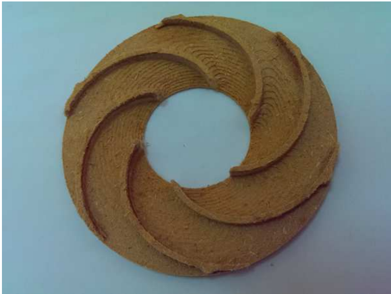
Figure 5- 31 : L'usinage de la tranche des aubes de la roue
