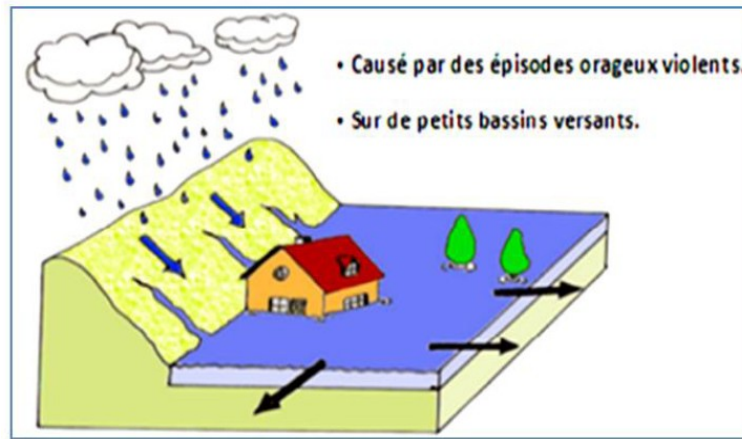
Figure I-2 : inondations par ruissellement pluvial [Djebali, 2014]
