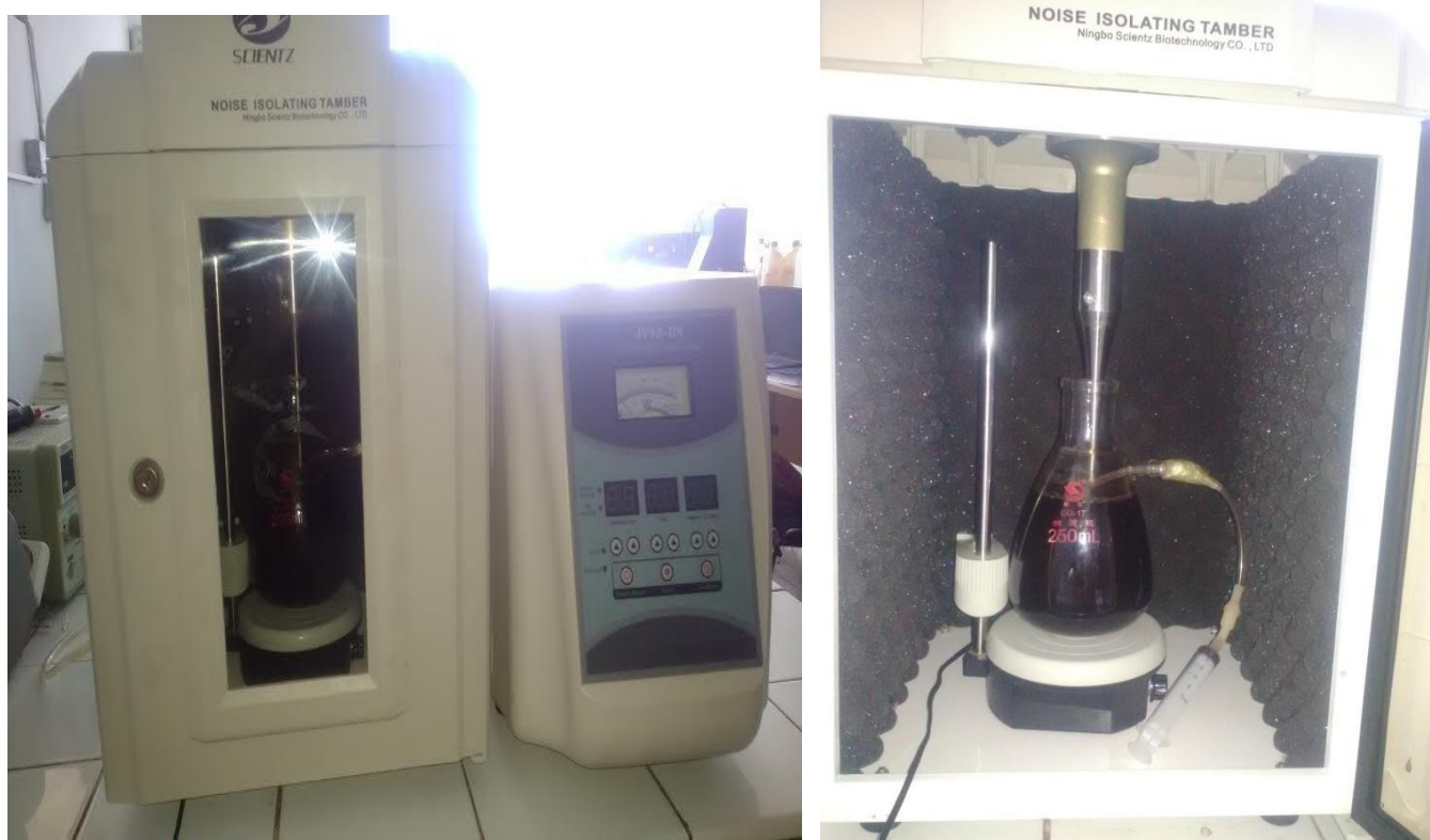
Figure IV: Dispositif d'Ultrasons utilisé
