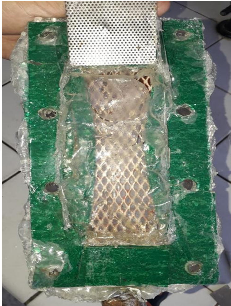
Figure IV.6: Etat de la membrane après le test.
