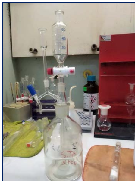
Figure 6.16 : L'extraction des hydrocarbures par l'hexane
