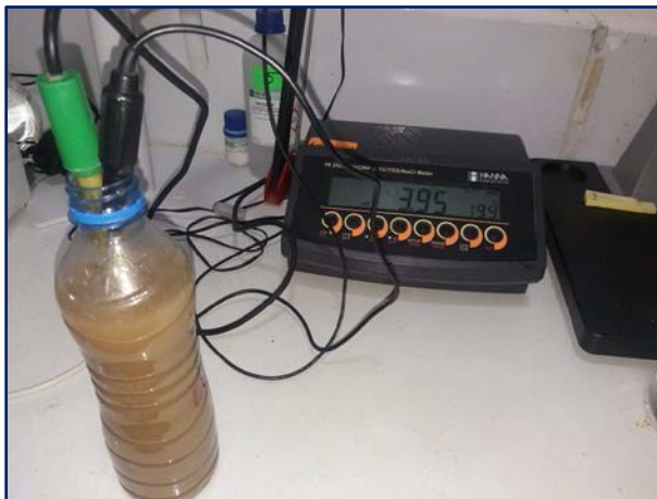
Figure 6.25 : mesure de la conductivité électrique des échantillons
