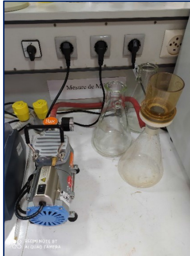
Figure 6.24 : filtration sous vide
