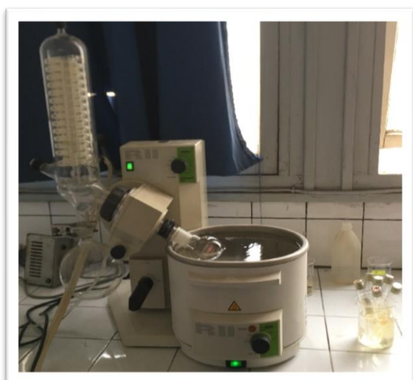
Figure 4.1 : Extraction des hydrocarbures du sol
