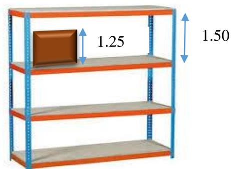
**Figure 38 : La hauteur des palettes par rapport à la hauteur des alvéoles**
