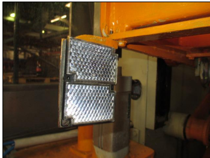
Figure 36 : Le capteur placé sur la deuxième extrémité de la barre portant les têtes de préhension.
