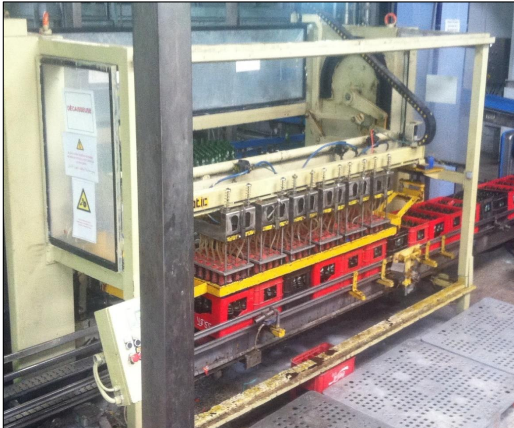
Figure 16 : Etat de la Décaisseuse avant le Nettoyage.
