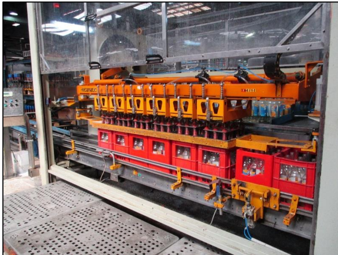
Figure 32 : Porte de la Décaisseuse ouverte et fixée automatiquement dans la position voulue.
