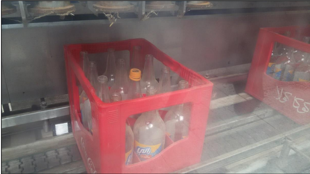
Figure 37 : Bouchon sur une bouteille de jus 'Rani' à la sortie de la Débouchonneuse.
