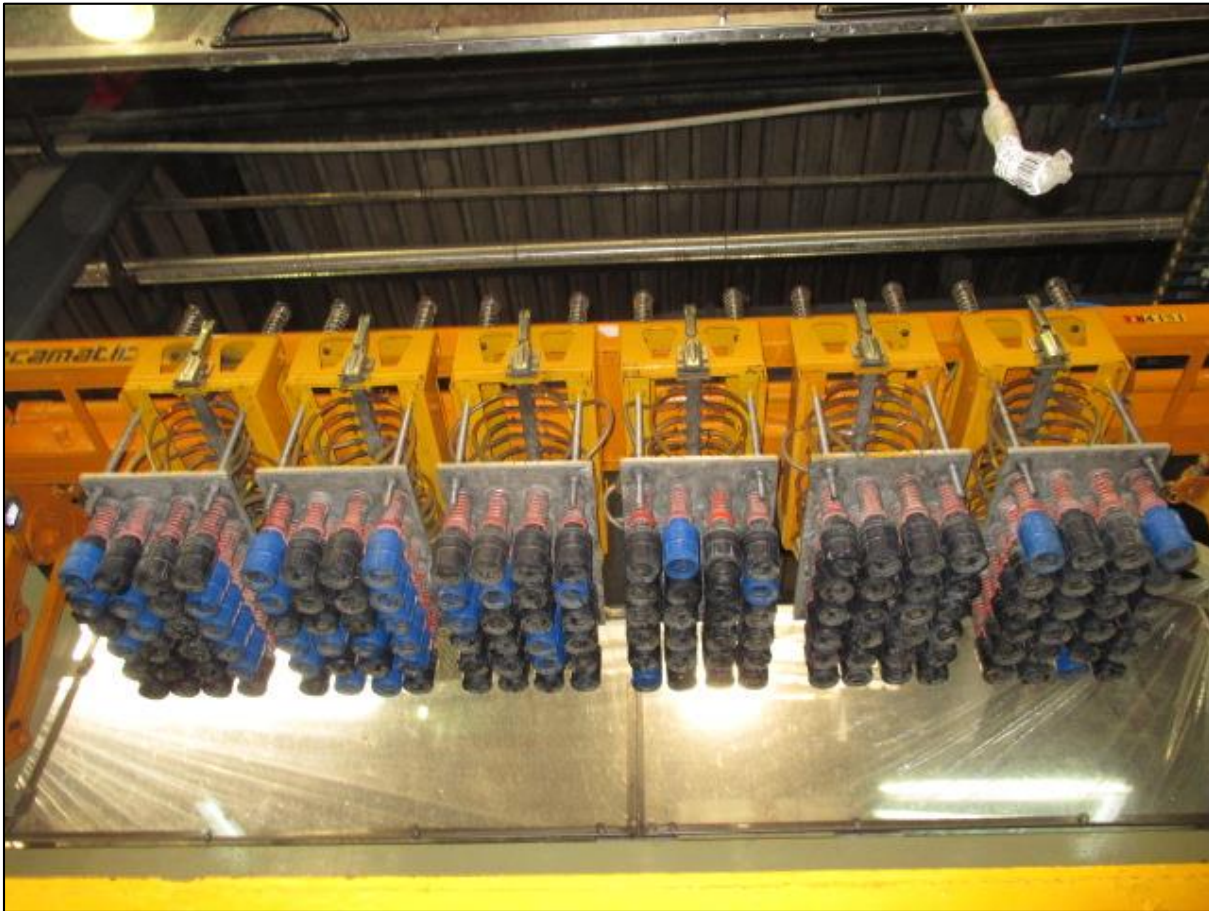
Figure 25 : Les pinces de prise : Vu de dessous.
