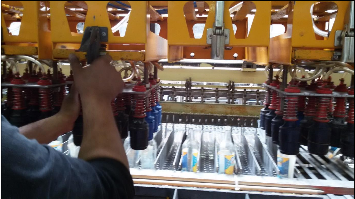
Figure 27 : Séances de Changement de Format : Remplacement des Têtes de préhension.
