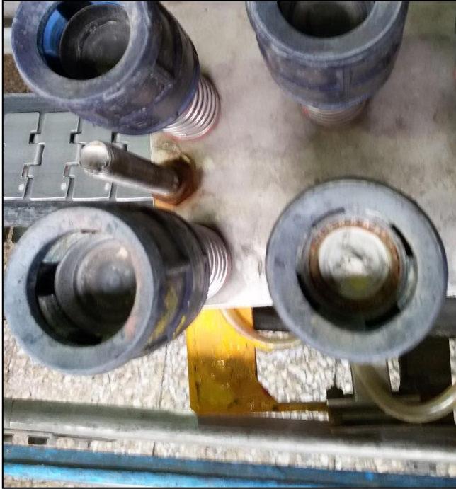
Figure 38 : Bouchon à l'intérieur d'une tête qui a été enlevé à cause de blocage d'une bouteille.
