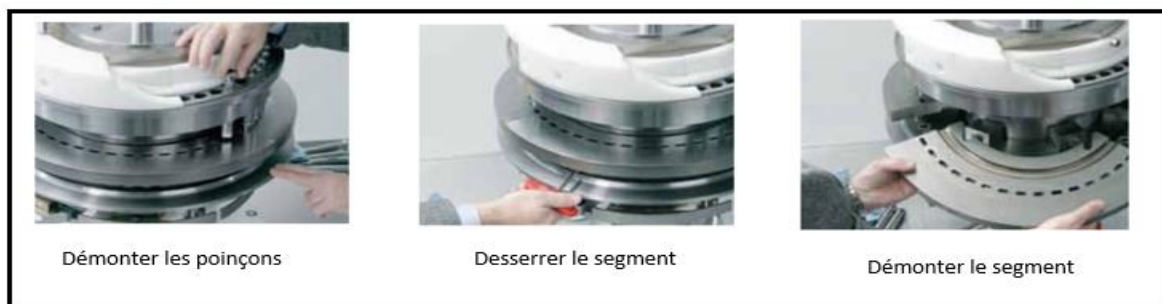
Figure V.15: avantage de la nouvelle tourelle lors d'un démontage
