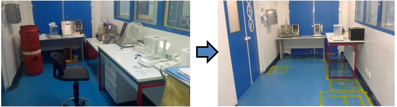
Figure IV.7: Exemple de marquage du sol dans l'atelier de compression
