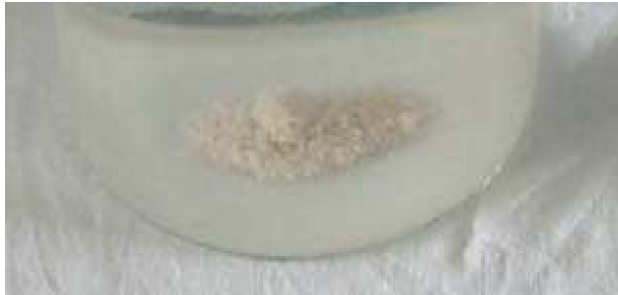
Figure IV.17 : Floccs formés lors de l'application du coagulant chimique
