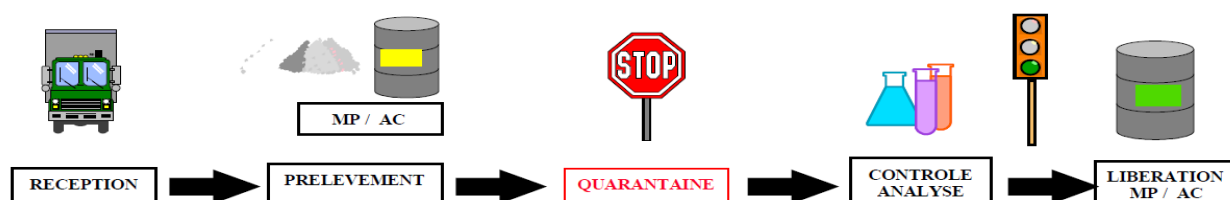
Figure 1-3 Processus de réception et de contrôle des matières (M. KADIRI,
