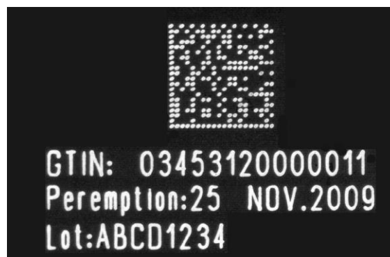
Illustration 2.11: Exemple d'impression en technologie laser
