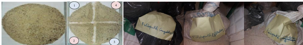
Figure 11 : principe d'échantillonnage par quartage
