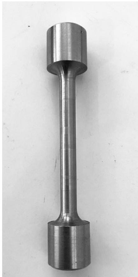
FIGURE 4.14 – L'éprouvette utilisée après élaboration
