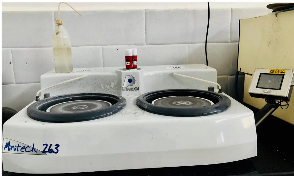
FIGURE 4.4 – La polisseuse mécanique utilisée
