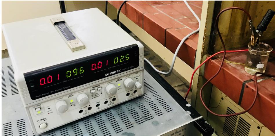
FIGURE 4.8 – Matériels utilisés pour l'attaque électrochimique
