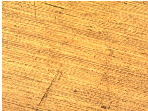
FIGURE 5.17 – Structure microscopique de l'échantillon après immersion dans la solution Ringer (x50)
