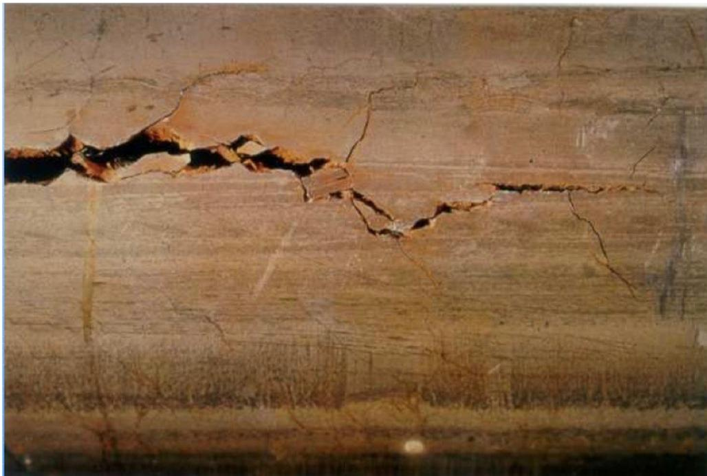
FIGURE 2.3 – Corrosion sous contrainte
