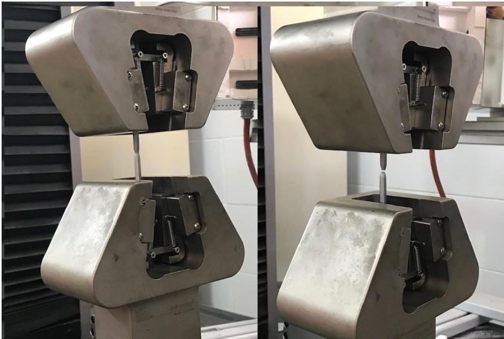
FIGURE 4.19 – Éprouvette de traction : avant rupture(à gauche) - après rupture(à droite)
