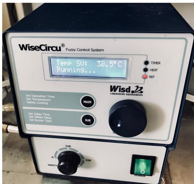
FIGURE 5.1 – Thermostat à circulation relié à la cellule thermostatée
