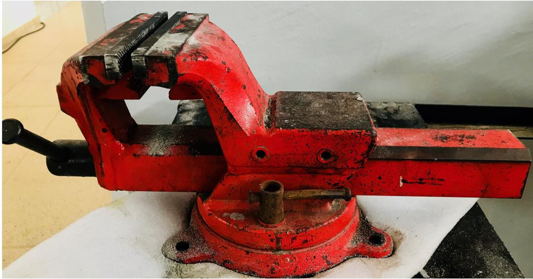
FIGURE 4.2 – L'étau d'établi utilisé
