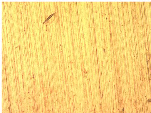
FIGURE 5.20 – Structure de l'échantillon après immersion dans l'eau distillée (x10)
