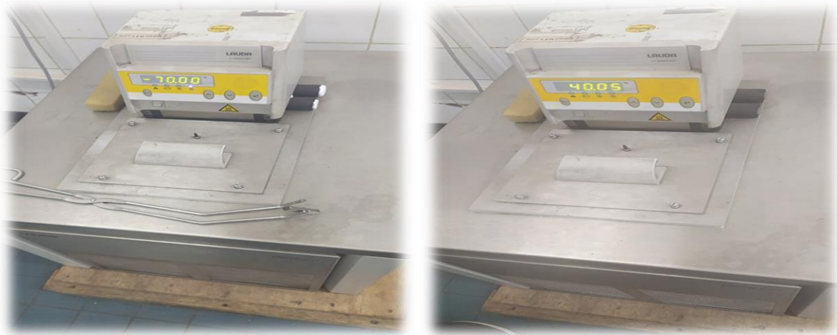
Figure II.1.23: Le thermorégulateur réglé de -70°C jusqu'à 40 °C avec des paliers de 5 ou 10°C.
