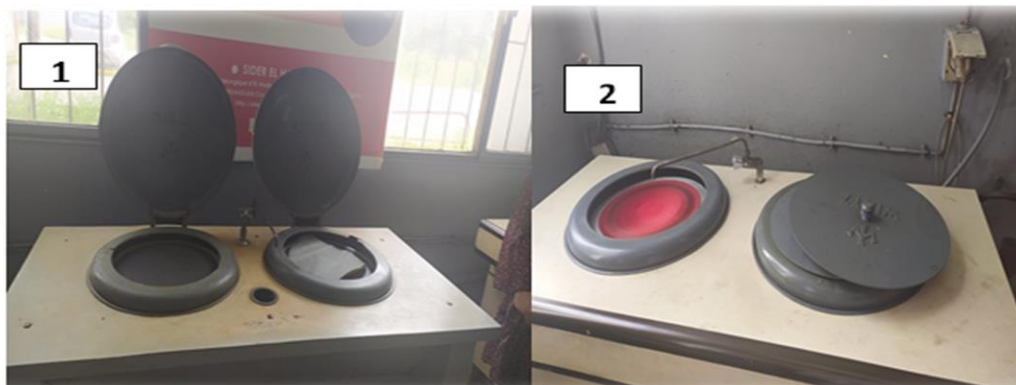
Figure II.1.13 : Polissage de l'échantillon : 1-Prépolissage sur les papiers abrasifs 2-Finition sur une pate diamantée
