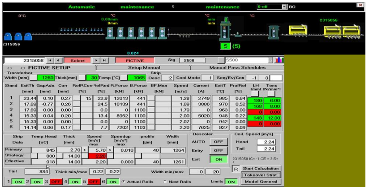
Figure II.3.4 : Plan de passe au niveau du train finisseur pour l'épaisseur 14mm
