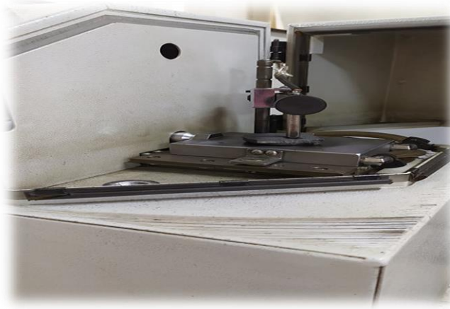
Figure II.1.4 : Chambre d'excitation du spectromètre à émission optique
