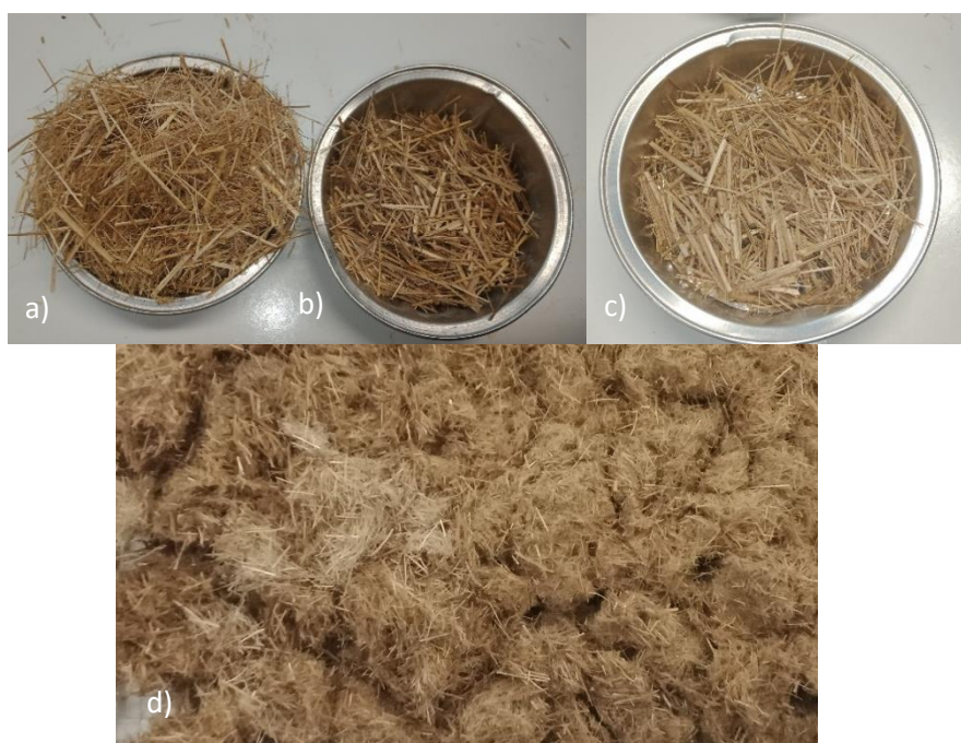
Figure III. 2. Résultats du broyage des feuilles de Diss après séchage : a) Feuilles non humidifiées broyées avec de l'eau, b) Feuilles non humidifiées broyées sans eau, c) Feuilles humidifiées broyées sans eau, d) Feuilles humidifiées broyées avec eau.
