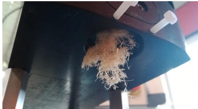
Figure III. 6. Blocage des fibres à l'intérieur du doseur volumétrique.
