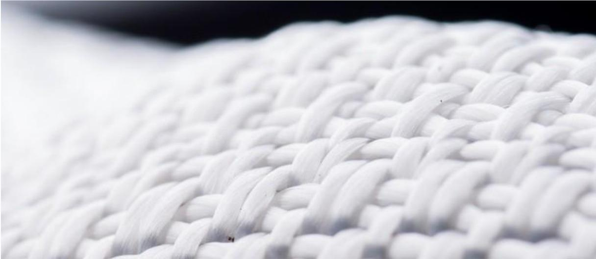
Figure 3.2 : Exemple du géotextile tricoté
