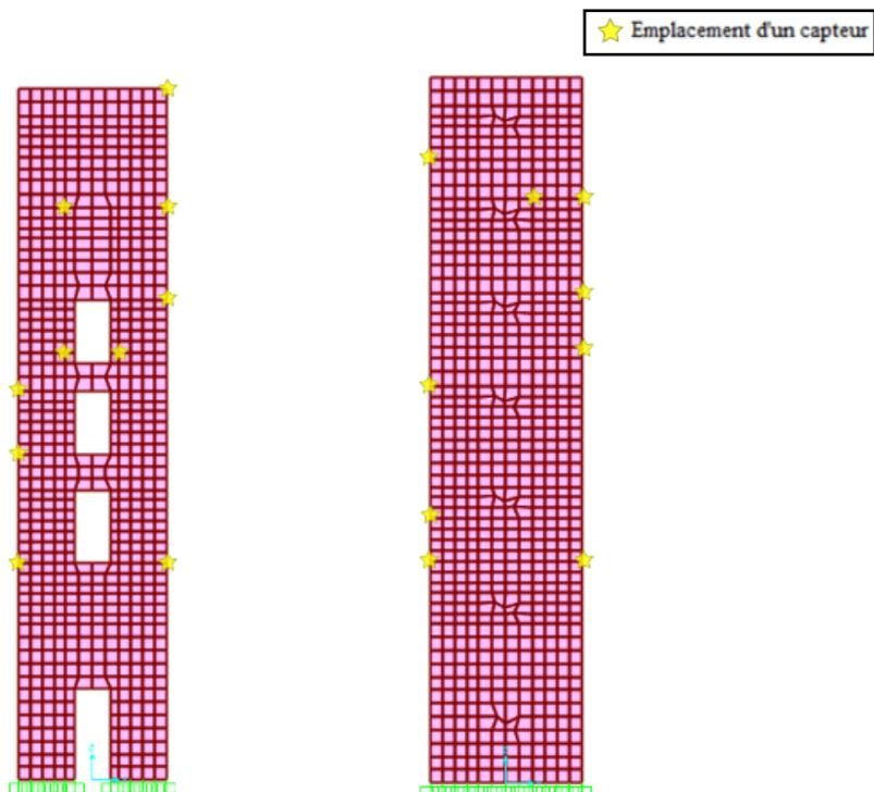
Figure III.19: Positions candidates suivant le plan  $(oyz)$
