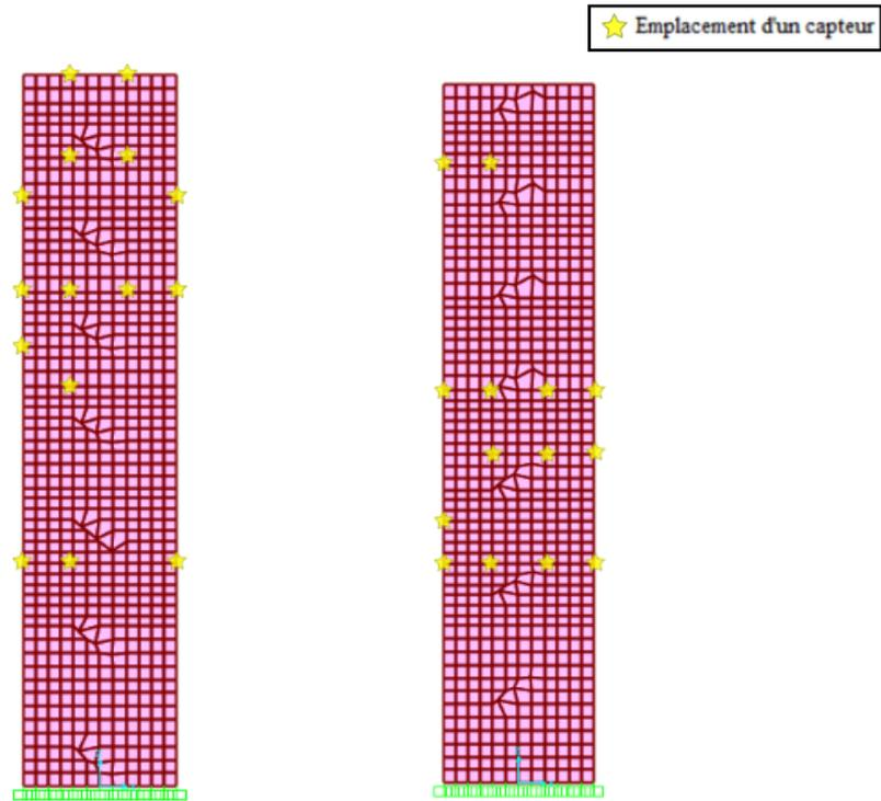
Figure III.20: Positions des capteurs suivant le plan (oxz)
