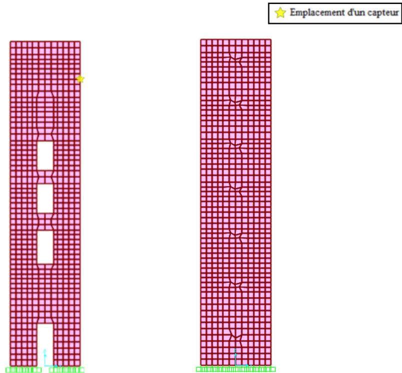
Figure III.21: Positions candidates suivant le plan (oyz)
