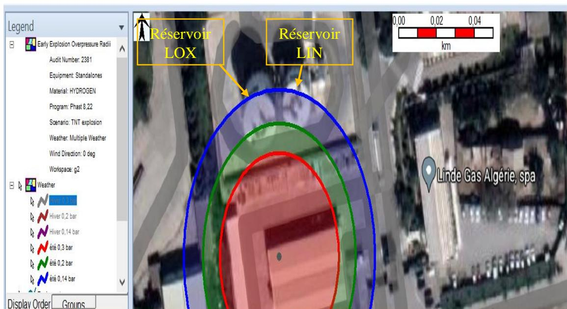
Figure III- 9 : Propagation de l'effet de surpression suite à l'événement secondaire « Explosion du cadre de bouteilles H<sub>2</sub> »
