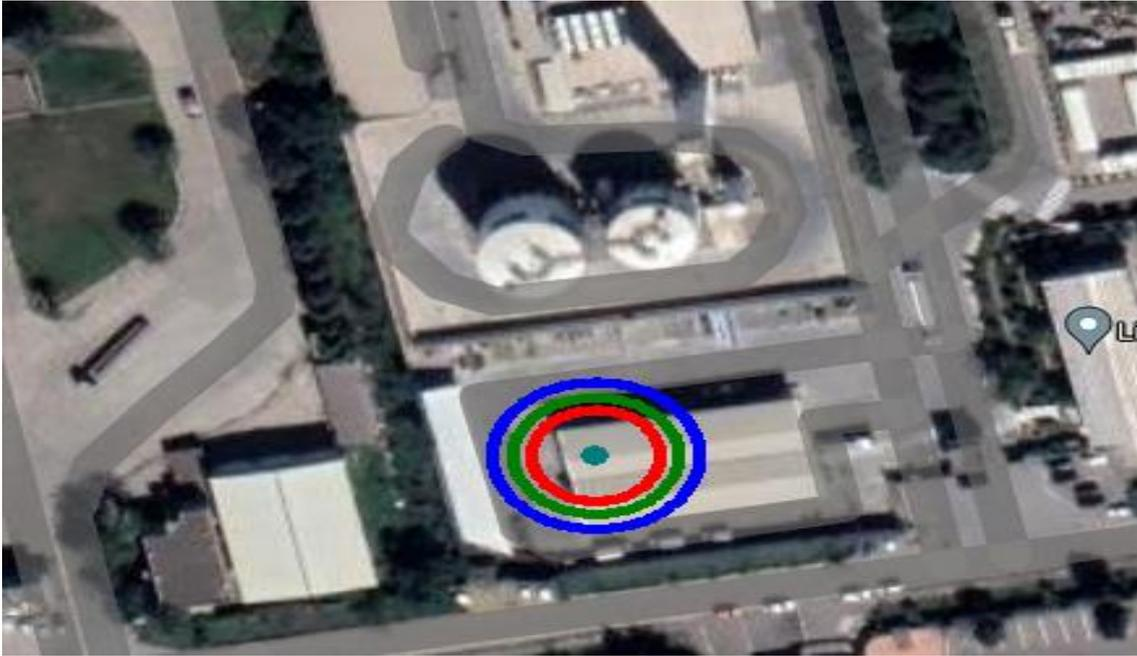
Figure III- 7 : Propagation des effets de surpression pour l'événement « VCE bouteille H<sub>2</sub> »
