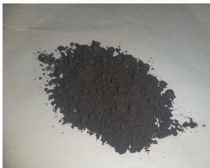
**Figure III.3.** Silicium obtenu après broyage.
