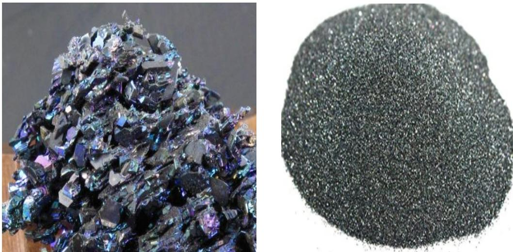
**Figure I.17.** Carbure de silicium : a) SiC synthétique et b) image des particules du SiC utilisées au CRTSE.
