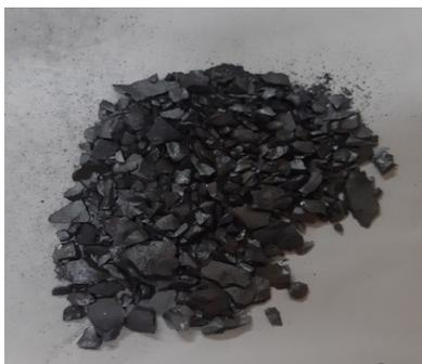
**Figure III.2.** Silicium obtenu après concassage.
