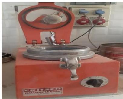
*Figure II.2.* Image de broyeur utilisé (type FRITSCH).
