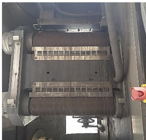
Figure I.12. La toile métallique d'une scie utilisée au CRTSE.
