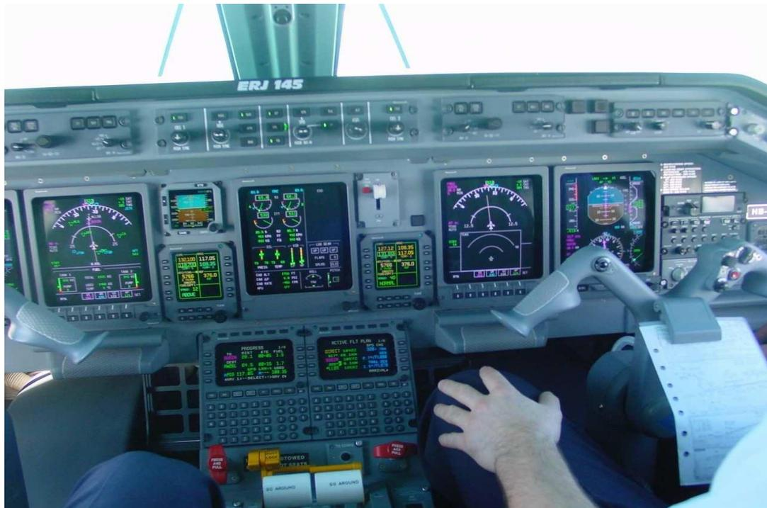
Figure 3-2 : Cockpit de nouvelle génération dit « glass cockpit » (Exclusif, 2021)
