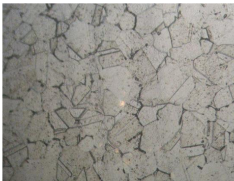
Figure 5-1 micrographie de l'acier inoxydable austénitique 310 à l'état de réception
