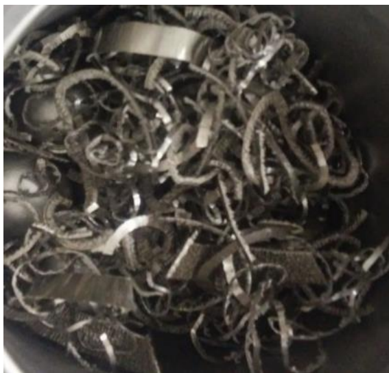
Figure 7-2 les copeaux initiaux dans la jarre du broyeur avant le broyage.
