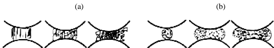
Figure 2-1 Effets de l'impact sur les matériaux fragiles (a) et ductiles (b).
