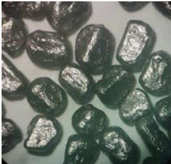
Figure 7-3 Photomicrographie optique, montrant l'évolution morphologique des particules de poudre vers une forme prismatique G=7
