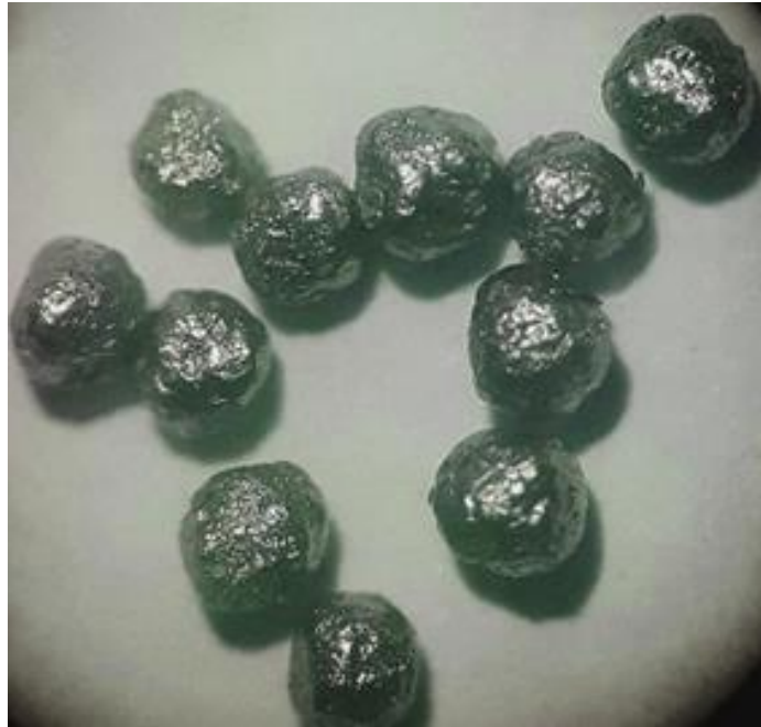
Figure 7-4 Photomicrographie optique montrant une forme sphérique évoluée des particules de poudre. G = \times 7
