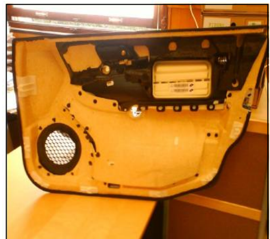
Figure 3-1 : Intérieur de portière Mercedes à base de fibres de chanvre
