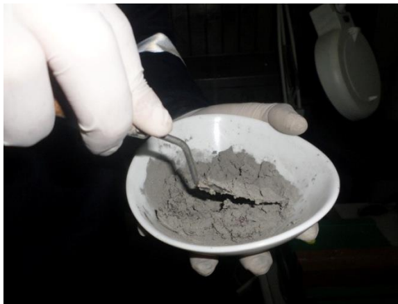
Figure 5-17 Préparation de la pâte "Renew Alloy"
