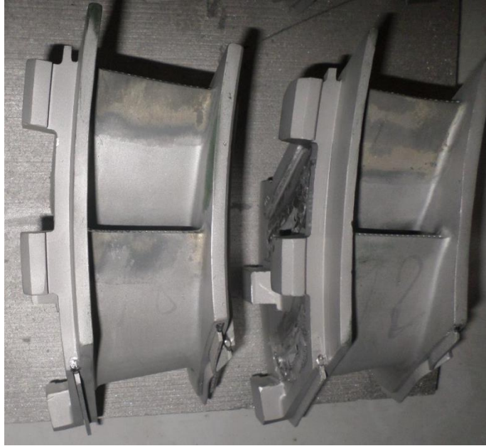
Figure 5-12 Etat de surface des segments après le traitement thermique
