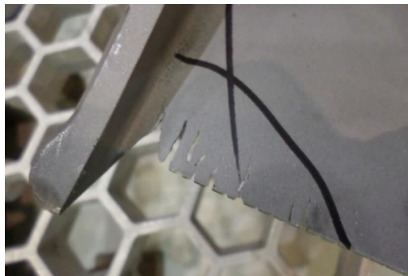
Figure 4-4 Bord de fuite (zone des trous de refroidissement) présentant un endommagement par usure
