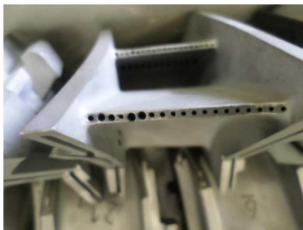
Figure 4-7 Elargissement des trous de refroidissement
