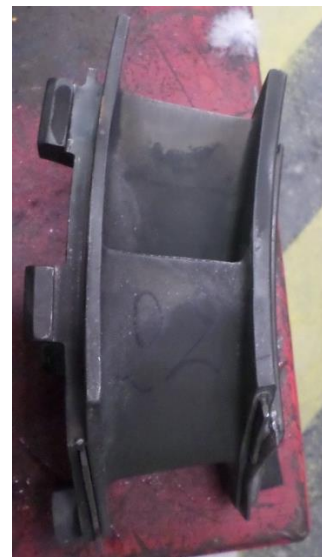
Figure 5-5 : Segment après nettoyage aux ultrasons
