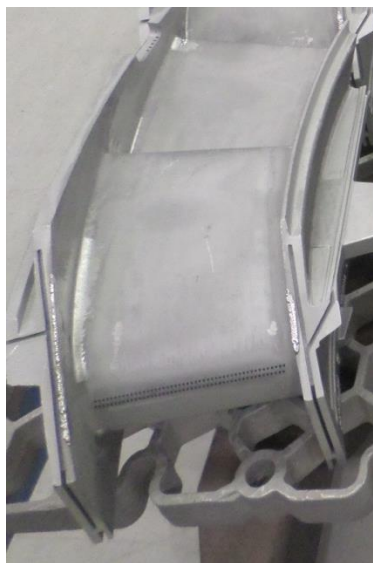
Figure 5-1 Couche d'oxyde sur un segment de directrice 1er étage
