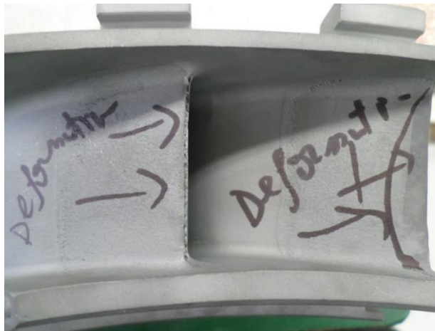
Figure 4-6 Déformation des bords de fuite
