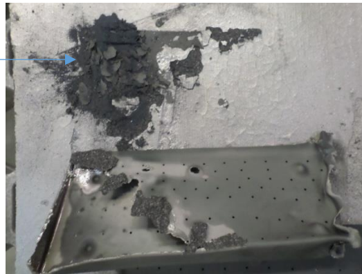
Figure 5-15 "Core plug" présentant plusieurs zones fondues après le traitement thermique
