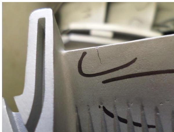
Figure 4-1 Fissuration du bord de fuite
