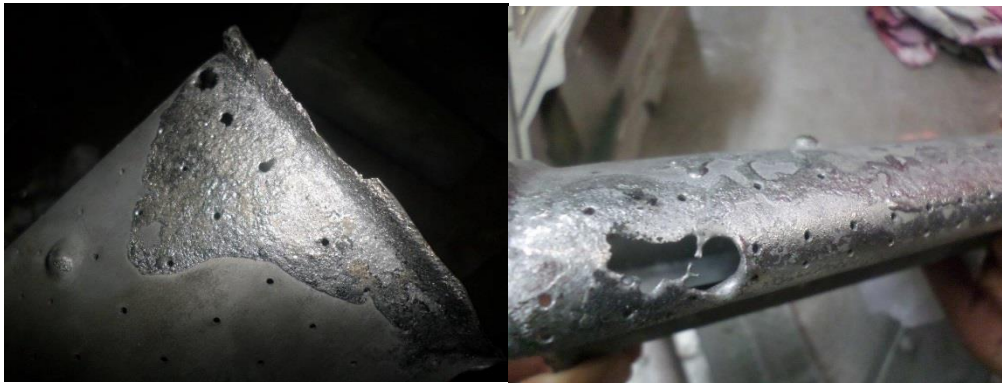
Figure 5-2 Fusion des « core plug » des segments après traitement thermique (Directrice modèle 9001)
