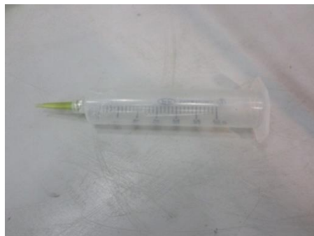
Figure 5-18 Seringue utilisée pour l'application de la pâte "Renew Alloy"
