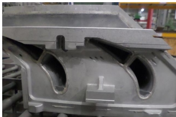
Figure 2-11 Localisation des 4 core plug dans le segment de directrice (Modèle 6000)
