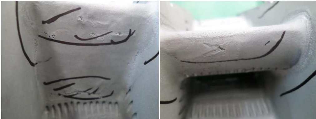
Figure 4-5 Bord d'attaque brûlé
