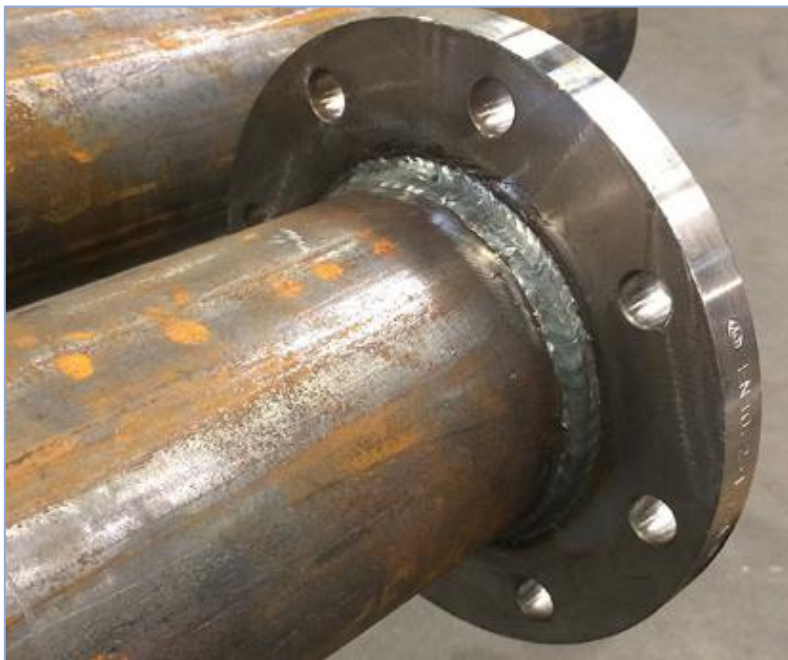
Figure I. 10. Assemblage tube sur bride (Épaisseur = 4mm, Diamètre = 139,7mm) [6]
