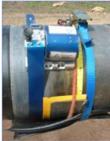
Figure I. 4. Dispositif du Gamma Prox développé par l'Institut de Soudure [3]
