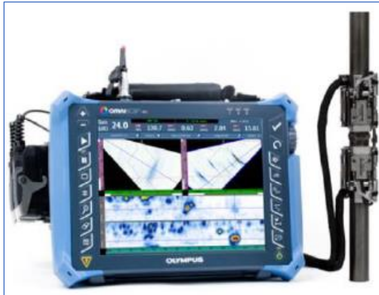
Figure I. 2. Equipements de contrôle ultrasons multiéléments - Olympus COBRA Scanner Phased Array [38]
