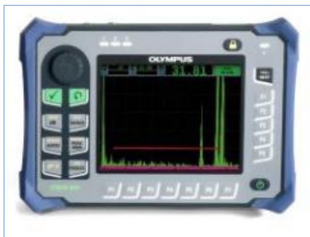
Figure I. 1. Appareil de recherche de défauts par ultrasons conventionnels - EPOCH 650 [46]
