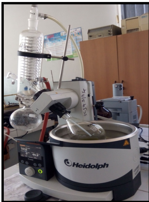
Figure 4-4 : Concentration de l'extrait par un rotavapeur
