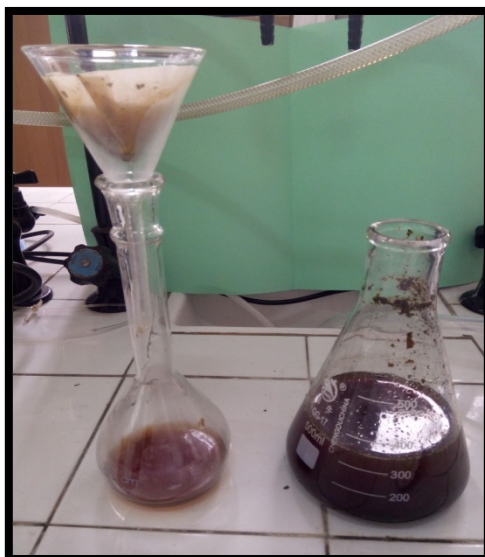
Figure 4-3 : macération des Maclura Pomifera
