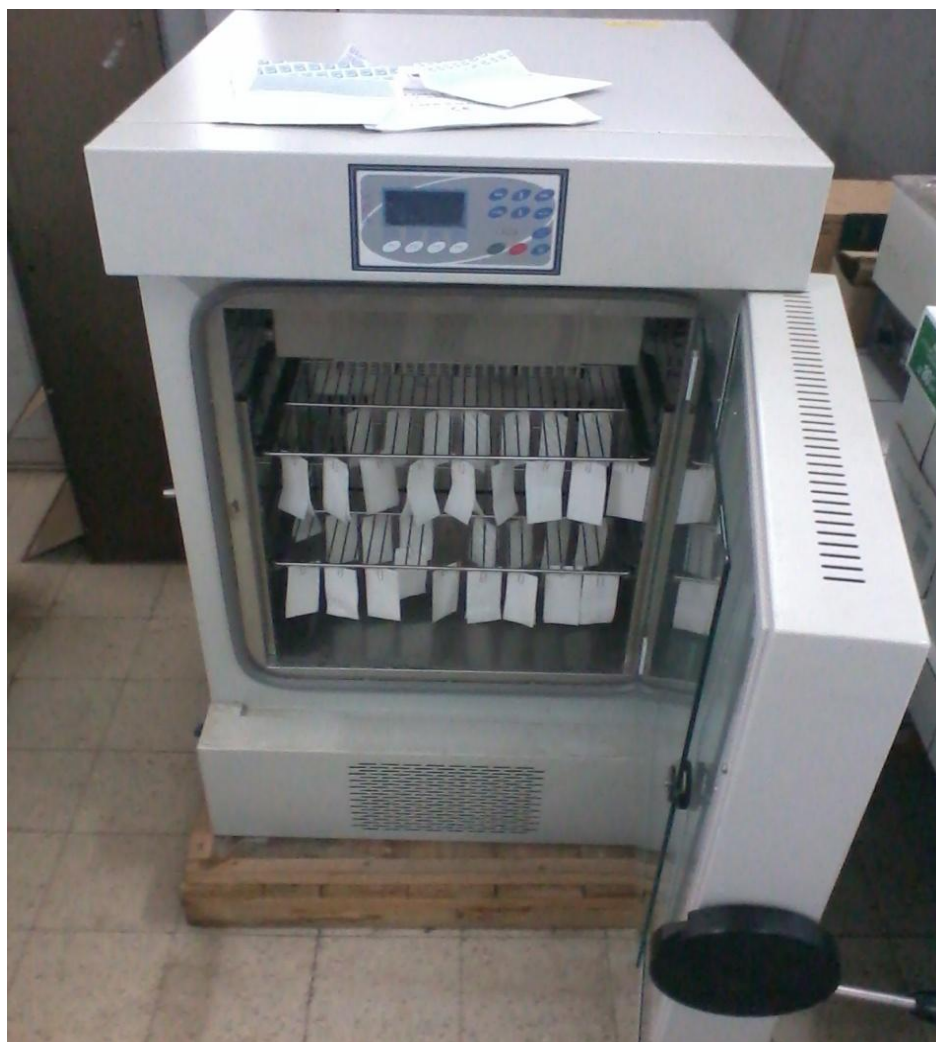
Figure IV. 1 : Echantillons dans l'enceinte climatique
