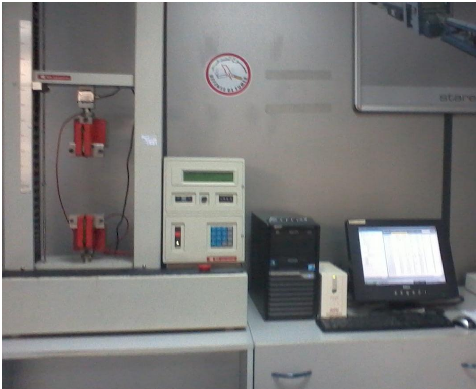
Figure IV. 2 : Testomètre assisté par ordinateur
