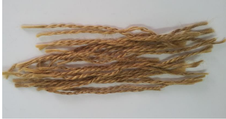
Figure 1:fibres de jute traitées par la soude
