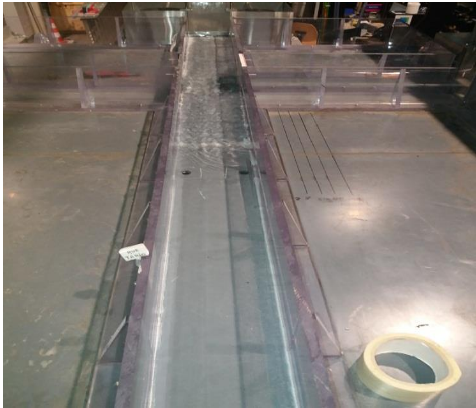
Figure III. 23 : cas de débordement avec deux avaloirs Q_{si} = 2 \text{ L/s} ; Q_{pi} = 0.5 \text{ L/s}
